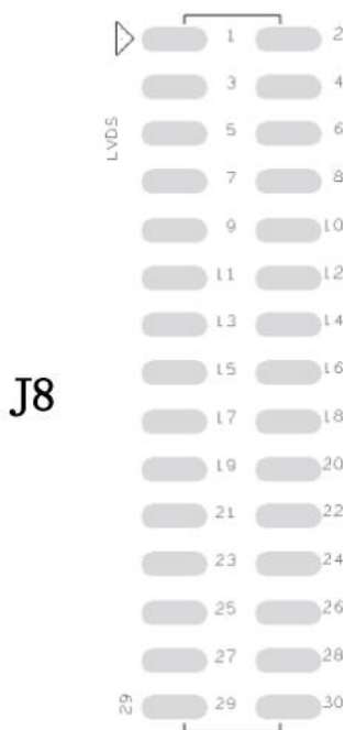
图 4 - 15 单通道 LVDS FPC 接口示意图
