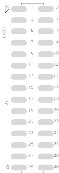
图 3 - 15 单通道 LVDS FPC 接口示意图
